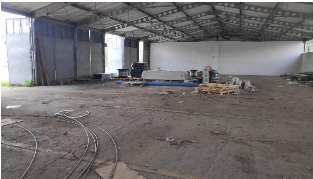
47. Posadzka betonowa – pola dylatacyjne. Widoczne dźwigary stalowe i bramy garażowe.
