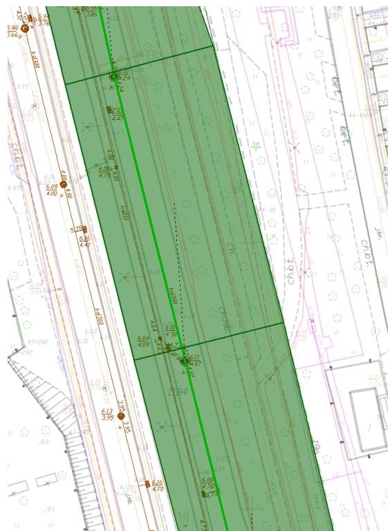
Rysunek 10. Przykład wyznaczania granic zlewni częściowych na terenie dróg
