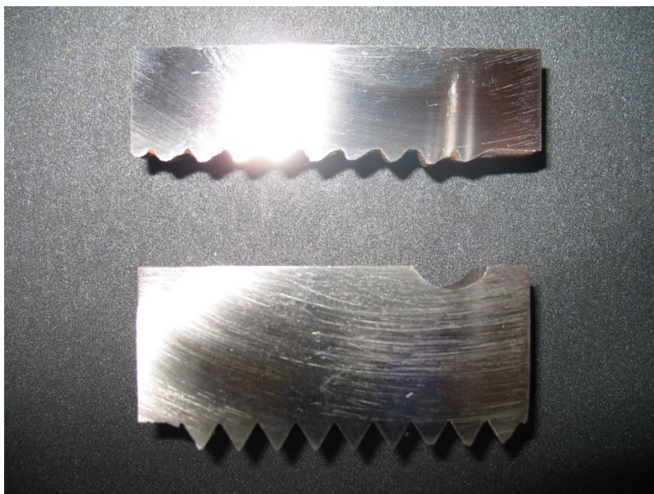
Rysunek 3. Porównanie przekrojów gwintu nowego i skorodowanego.
