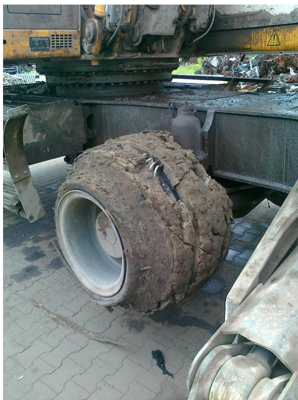
Rysunek 7. Ponadnormatywne zużycie koła jezdno żurawia samojezdno.
