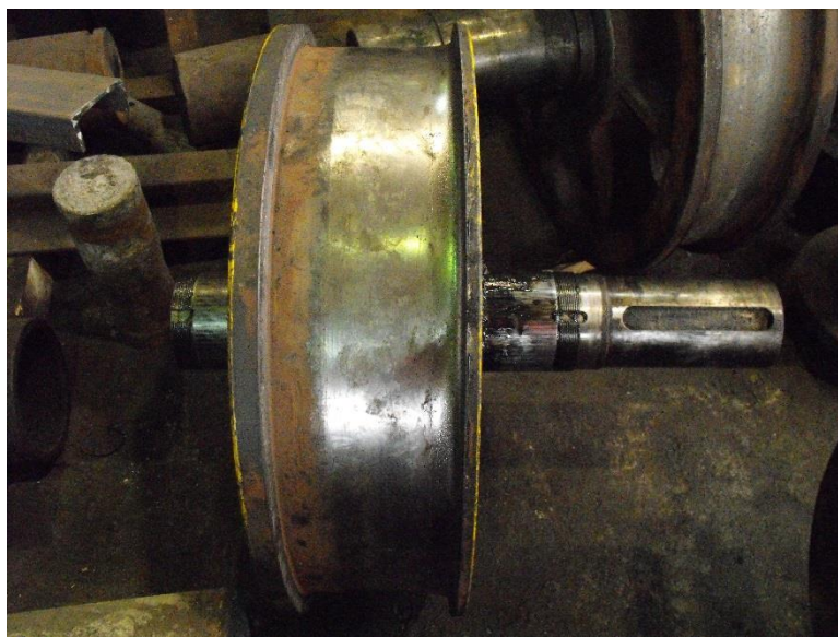
Rysunek 6. Ponadnormatywne zużycie koła jezdno suwnicy pomostowej.
