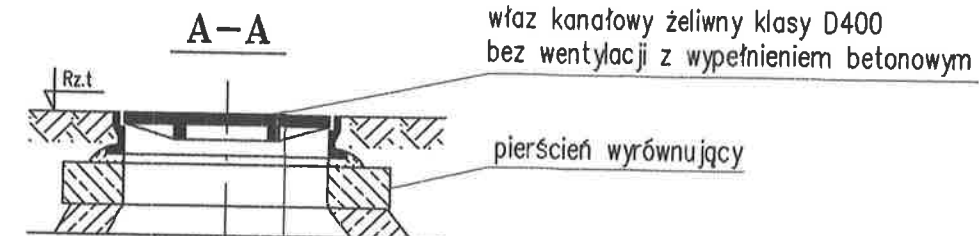
OSADZENIE WŁAZU POD DROGĄ ASFALTOWĄ
