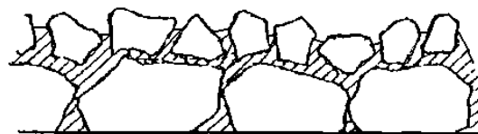
Rys. 3. Schematyczny obraz powierzchniowego utwardzenia nawierzchni typu „sandwich”
