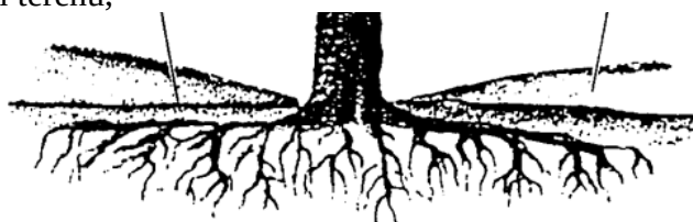
A - pierwotny poziom gruntu B - obsypka z lekkiej ziemi
