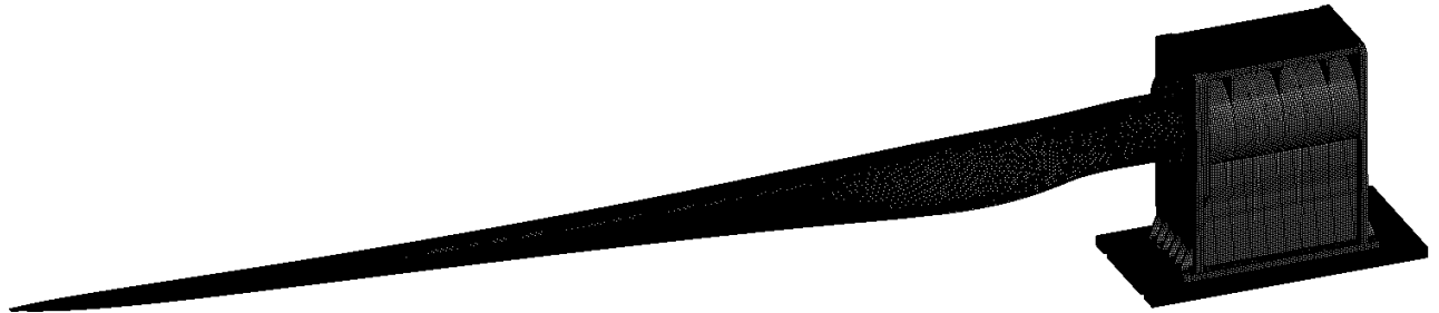
Rys. 5.5 Widok modelu MES do obliczeń dynamicznych, konfiguracja „flapwise”.
