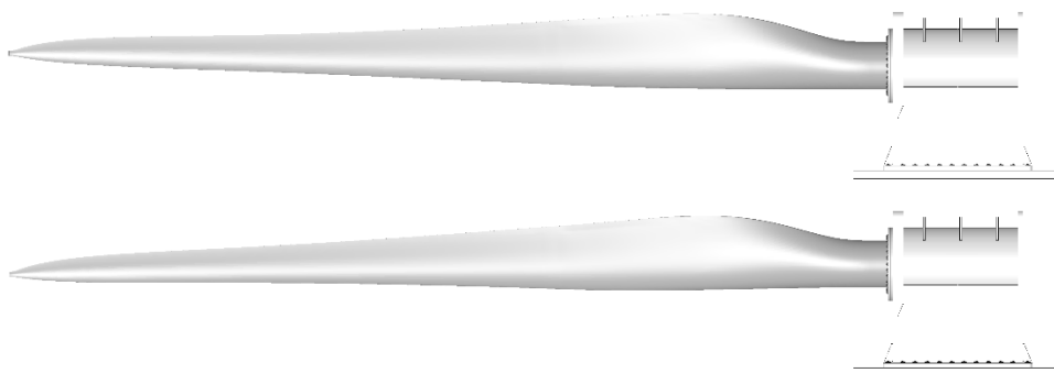
Rys. 8.22 Skrajne położenia końca łopaty w czasie badań dynamicznych.
