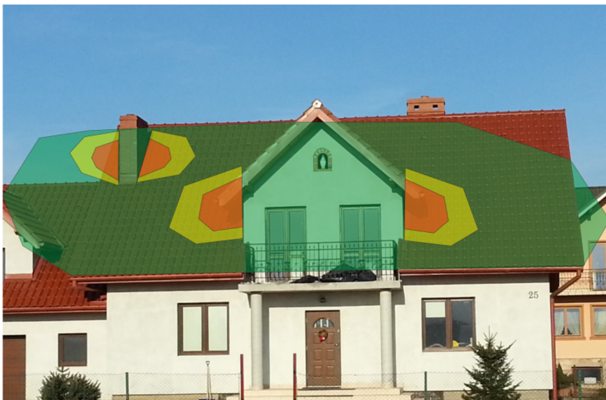
Rysunek 6 Strefy zacienienia na dachu skierowanym na południe
