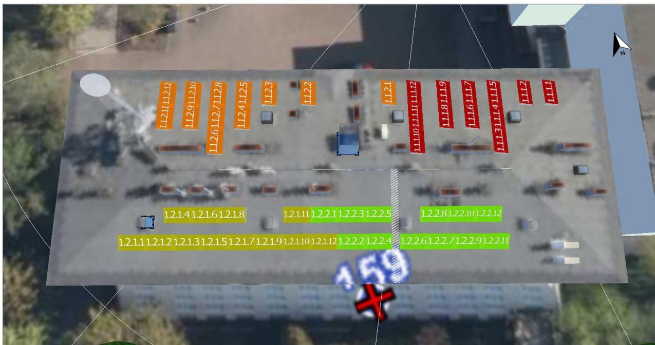
Ilustracja: Rozkład połączeń modułów PV
