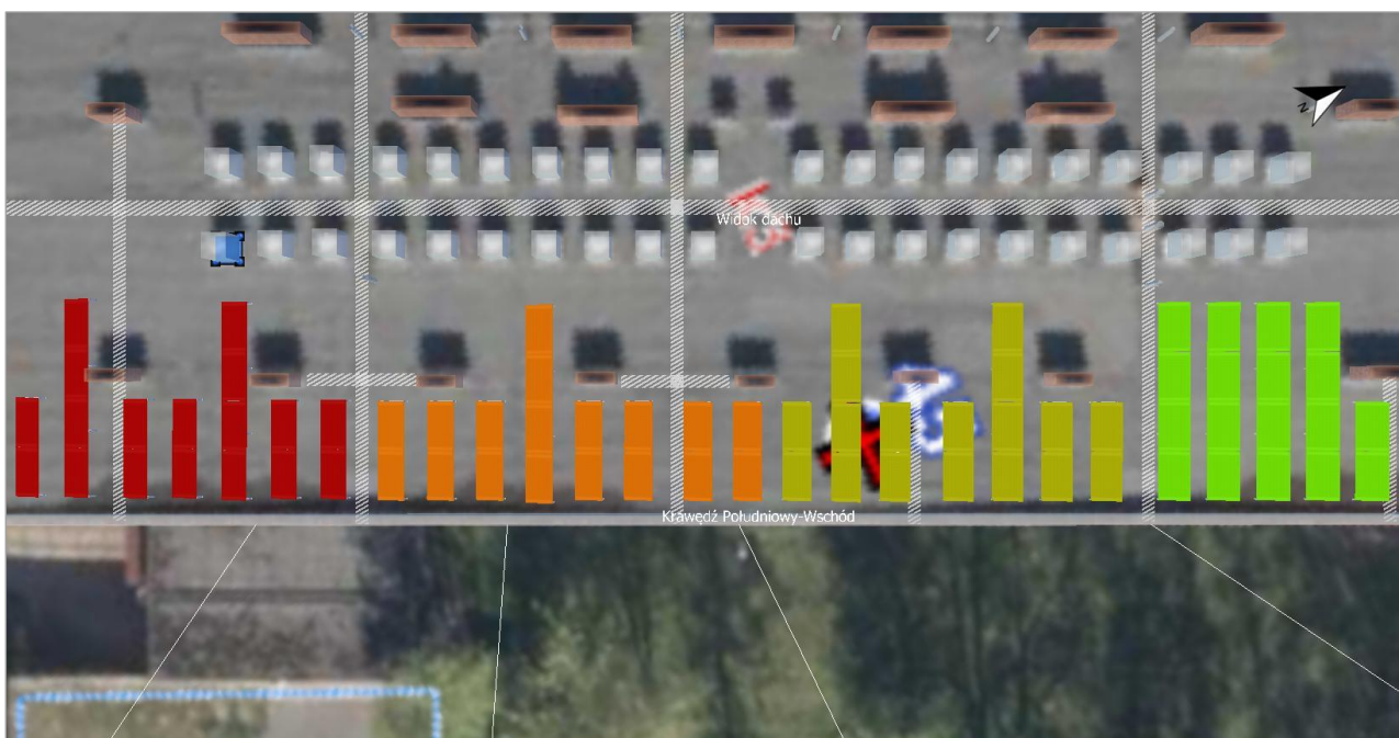
Ilustracja: Rozkład połączeń modułów PV
