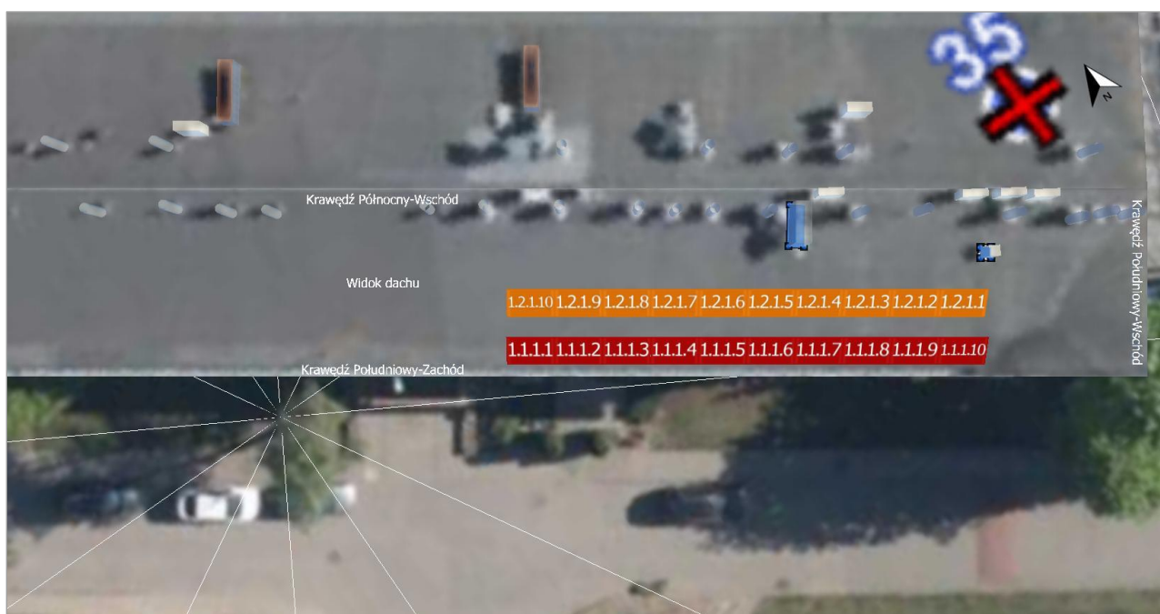
Ilustracja: Rozkład połączeń modułów PV
