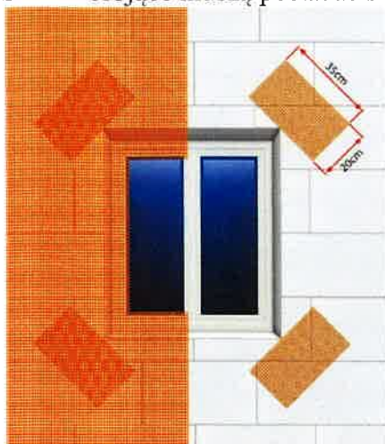
Prawidłowe wzmocnienie narożników otworów okiennych
