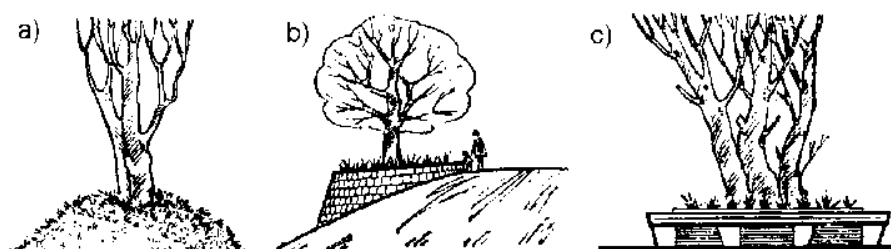
a) pozostawiony ścięty stozek z gruntu, ochraniający korzenie drzewa b) ścianka podporowa z kamienia wokół drzewa pozostawionego na skarpie
