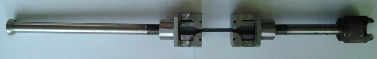
Cięgła do płaskich próbek z główkami do badań petzania z pomiarem wydłużenia - 5 kompletów cięgieł (Uwaga: zdjęcie z zamocowaną próbką)
