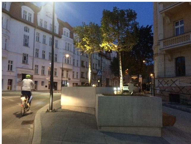
Fotografia 6. Przykład wysokich donic na chodniku z małą architekturą – takie rozwiązanie wymaga zapewnienia stałego podlewania roślin lub systemu nawadniania roślin
