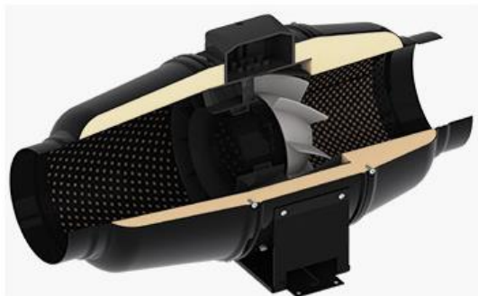
Rys. 56: Wytłumiony wentylator osiowy 800/1000 m 3 , 31/36 dB, Dalap AP 200 Quiet.
