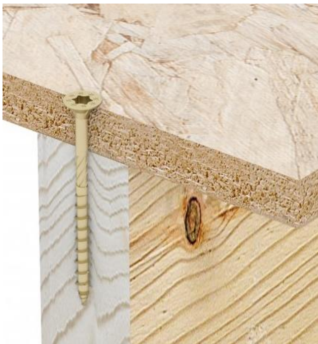
Rys. 23: Połączenie typu T, na przykładzie mocowania półki, wkręt przechodzi na wylot przez płytę pod kątem 90 stopni
