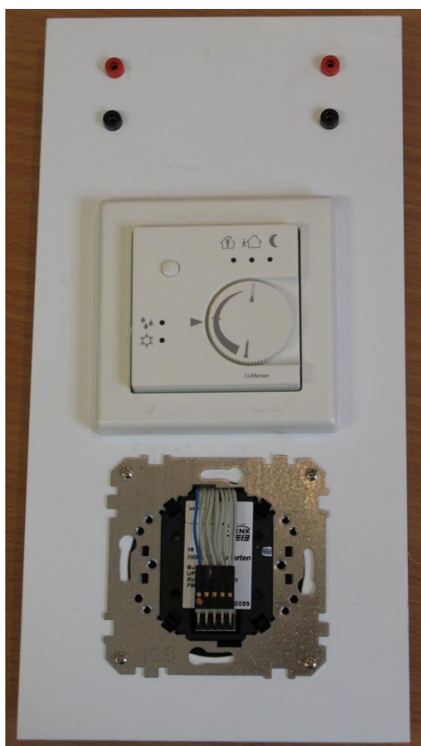
Rys. 14 Przykładowe zdjęcie istniejących elementów stanowisk dydaktycznych KNX - pokojowy regulator temperatury
