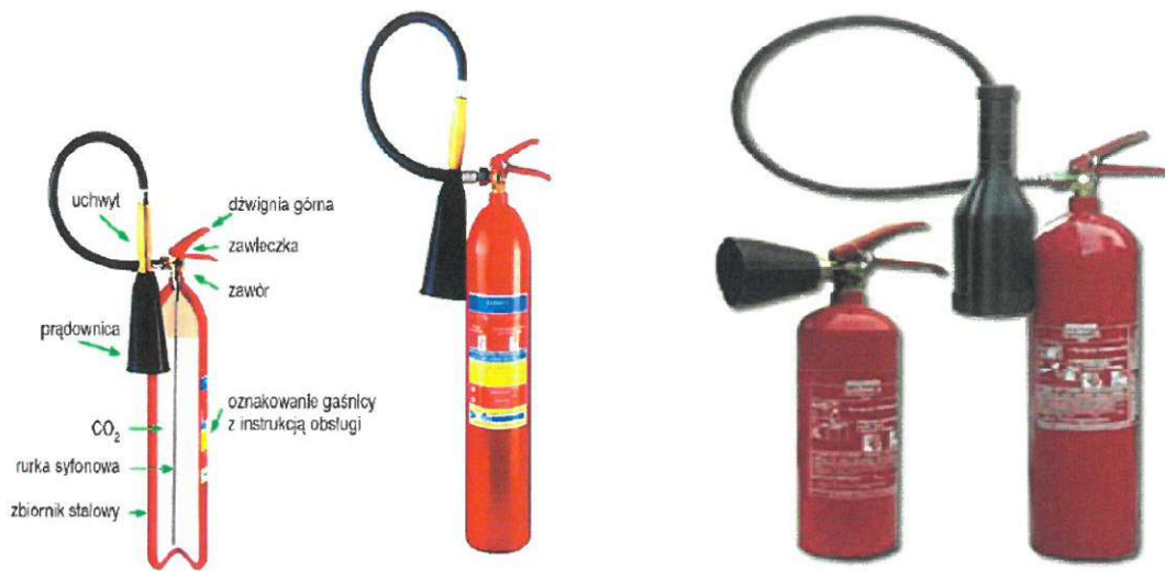
Rysunek 2 Gaśnice śniegowe widok i przekrój
