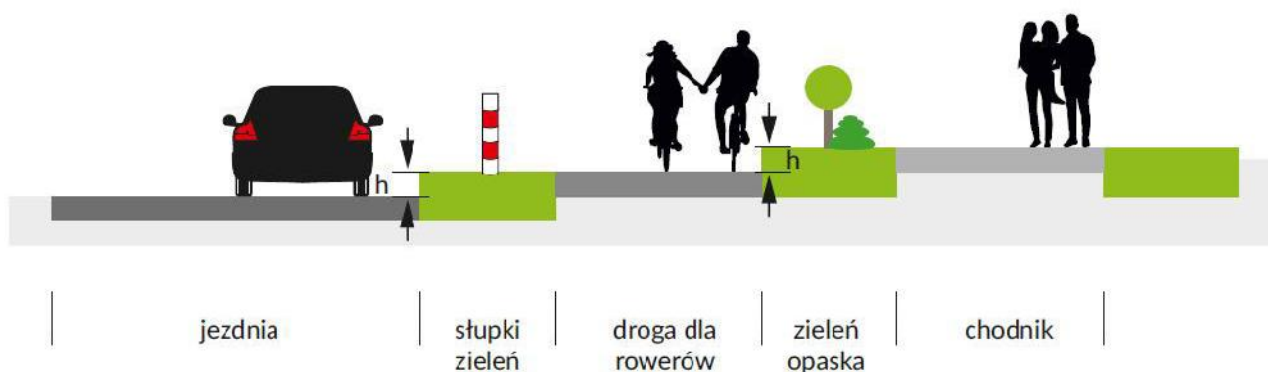
Rysunek 35. Schemat wydzielenia ruchu samochodów, rowerzystów i pieszych (bez oznakowania).
