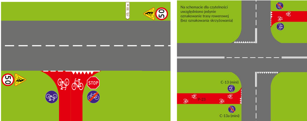
Rysunek 44- 45. Przykład wprowadzenia drogi rowerowej na drogę publiczną. Źródło: opracowanie własne.
