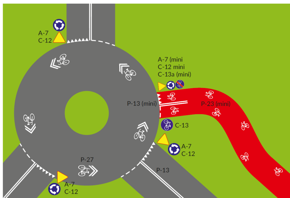
Rysunek 47. Początek/koniec drogi rowerowej na rondzie. Źródło: opracowanie własne
