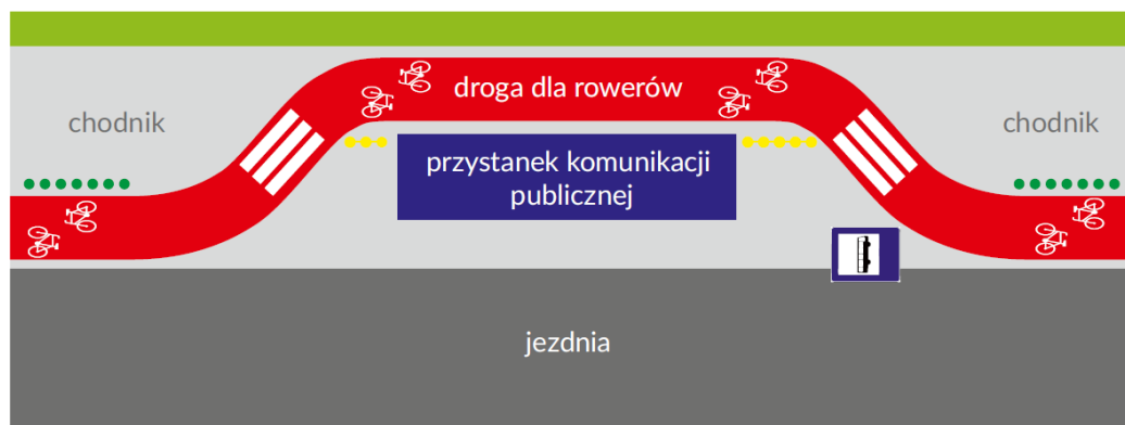
Rysunek 61. Droga rowerowa poprowadzona za przystankiem komunikacji publicznej. Źródło: opracowanie własne.
