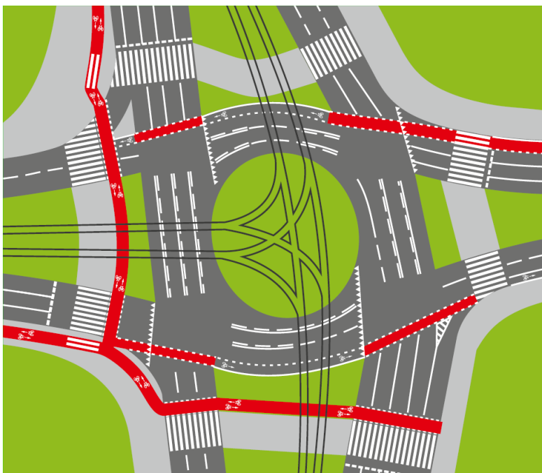
Rysunek 50. Organizacja ruchu rowerowego na skrzyżowaniu w ruchu ogólnym – pasy ruchu dla rowerów (schemat uproszczony, bez oznakowania). Źródło: opracowanie własne.
