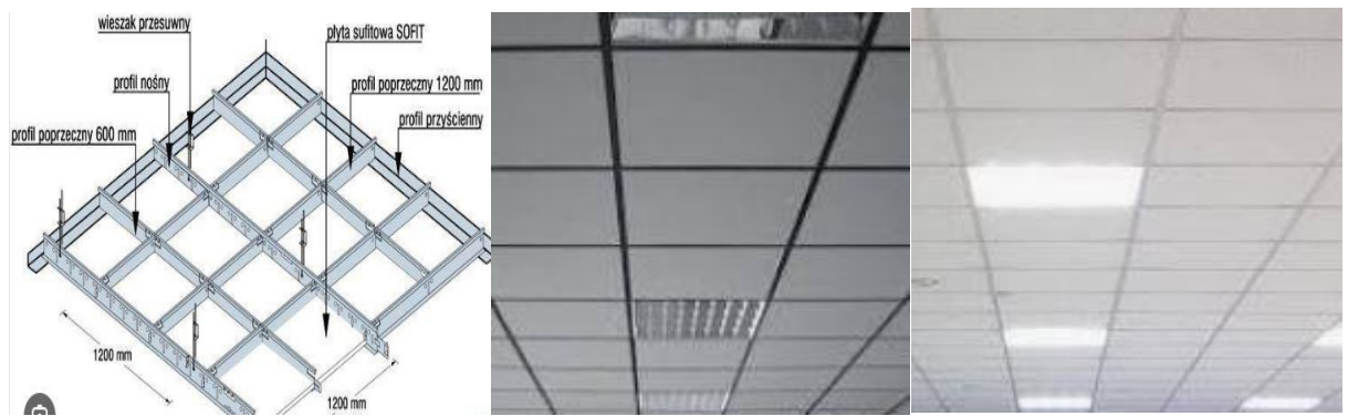
Rys. Przykłady konstrukcji stropów podwieszanych
