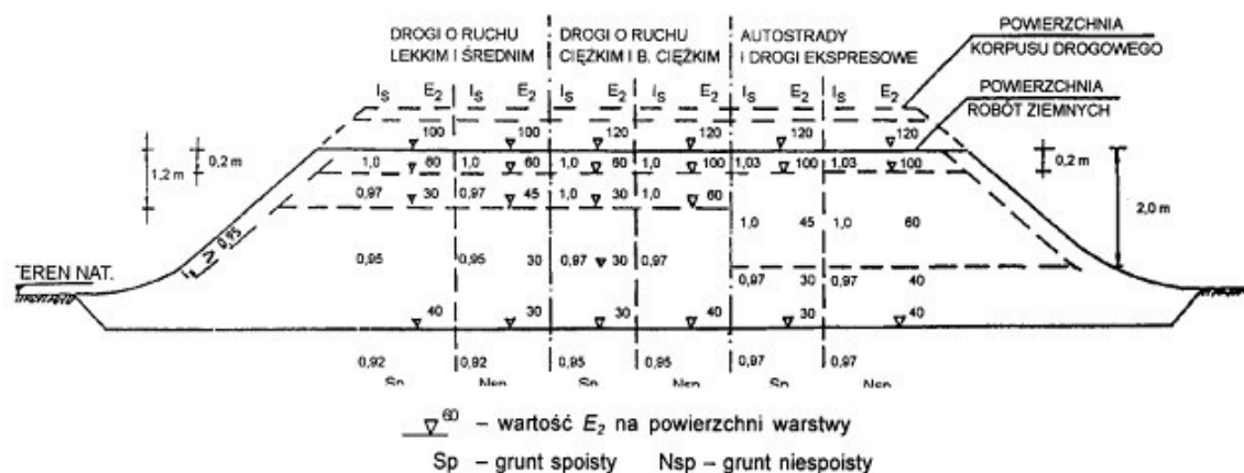
Rys. 1. Wartości wymagane w nasypach: wskaźnika zagęszczenia I_s i wtórnego modułu odkształcenia E_2 , w [MPa], wg [1].
