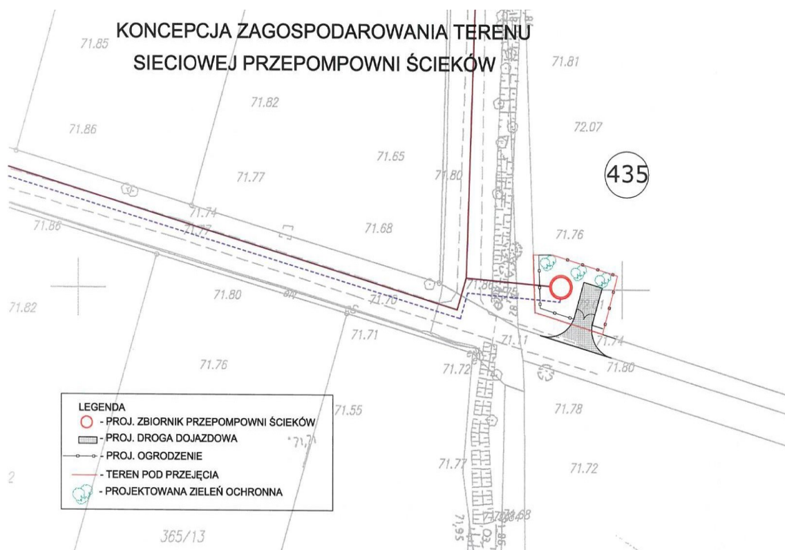
Rys. 1 Koncepcja zagospodarowania terenu sieciowej przepompowni ścieków
