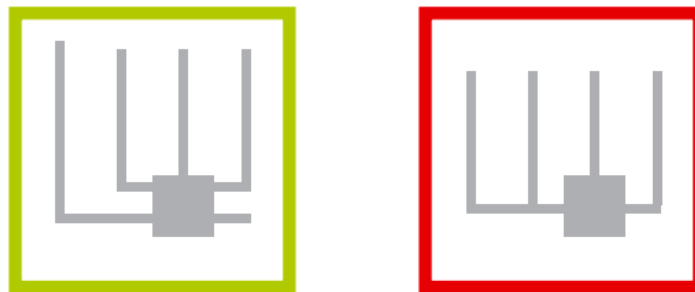
Rysunek 7. Schemat podłączenia drenażu do studzienki rozdzielającej
