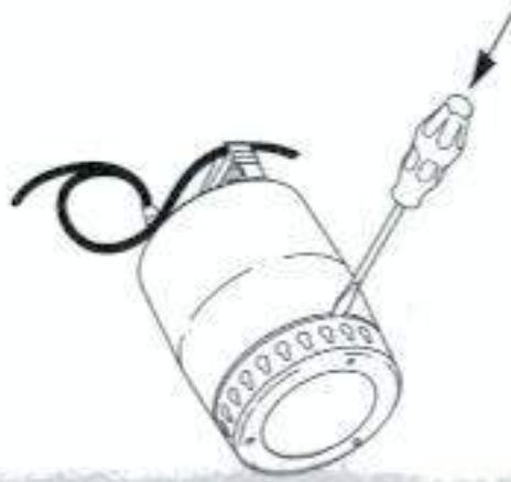
Rys. 10 W jaki sposób usunąć kosz wlotowy
