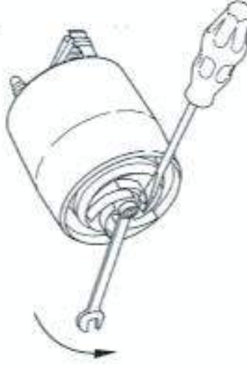
Rys. 13 Demontowanie wirnika
