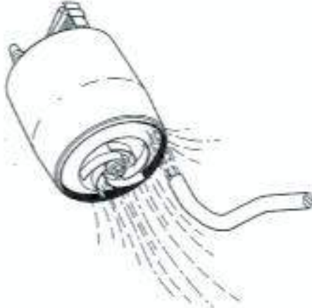
Rys. 12 Czyszczenie pompy
