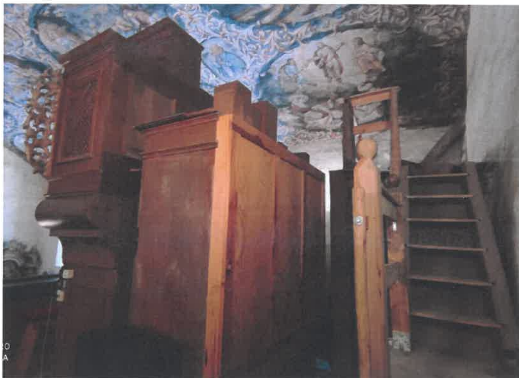
Zdj.17-18. Prospekt organowy XVIII w., kościół p.w. Świętej Trójcy, parafia Sokolowiec, gm. Świerzawa, woj. dolnośląskie. Odwrocie, widoczne dwie skrzynie w których rozmieszczono cały mechanizm instrumentu.
