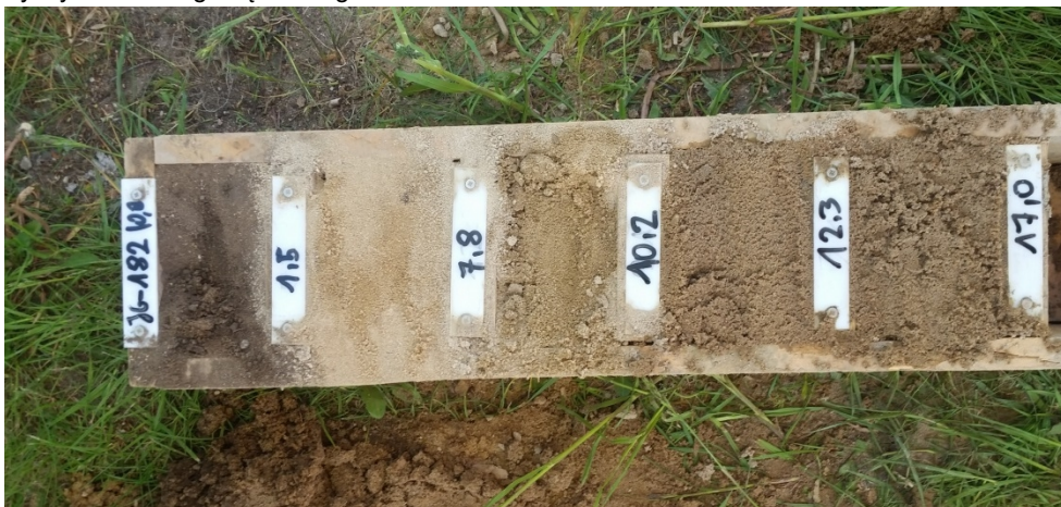
Fot. 1 Przykład dokumentowania fotograficznego przewierczanych gruntów
