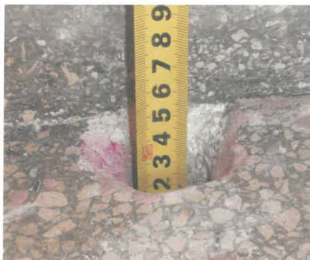
Rys. 5.1. Pomiar grubości warstwy lastriko na stopniu
