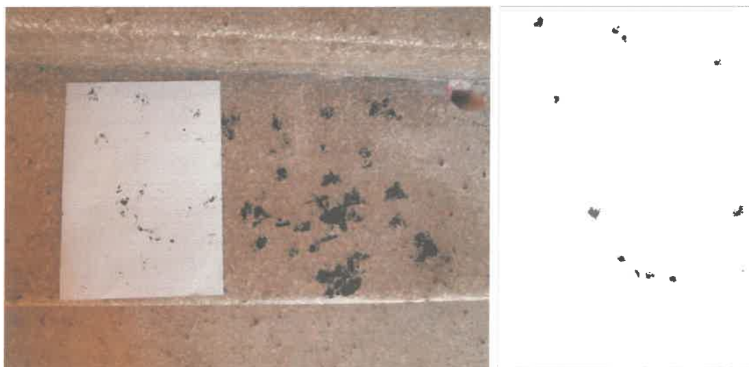
Rys. 5.3. i 5.4. Zdjęcie wykonane podczas wykonania odbicia faktury powierzchni i rysunek przedstawiający rozmieszczenie wystających kamyczków.
