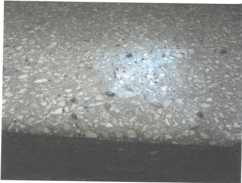
Rys. 8.17. Wystające pojedyncze kamyki bazaltowe i puste pory
