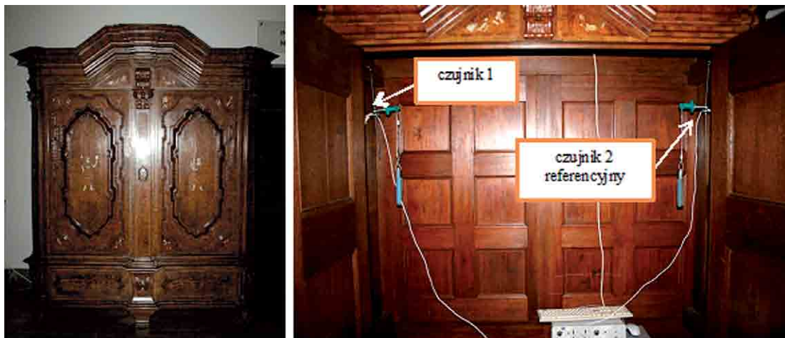
Rys. 12. Po lewej: XVIII-wieczna. szafa wrocławska eksponowana w sali 202 w Galerii Rzemiosła Artystycznego w Gmachu Głównym MNK, po prawej: antykorelacyjny układ do pomiaru emisji akustycznej zamontowany wewnątrz szafy.
