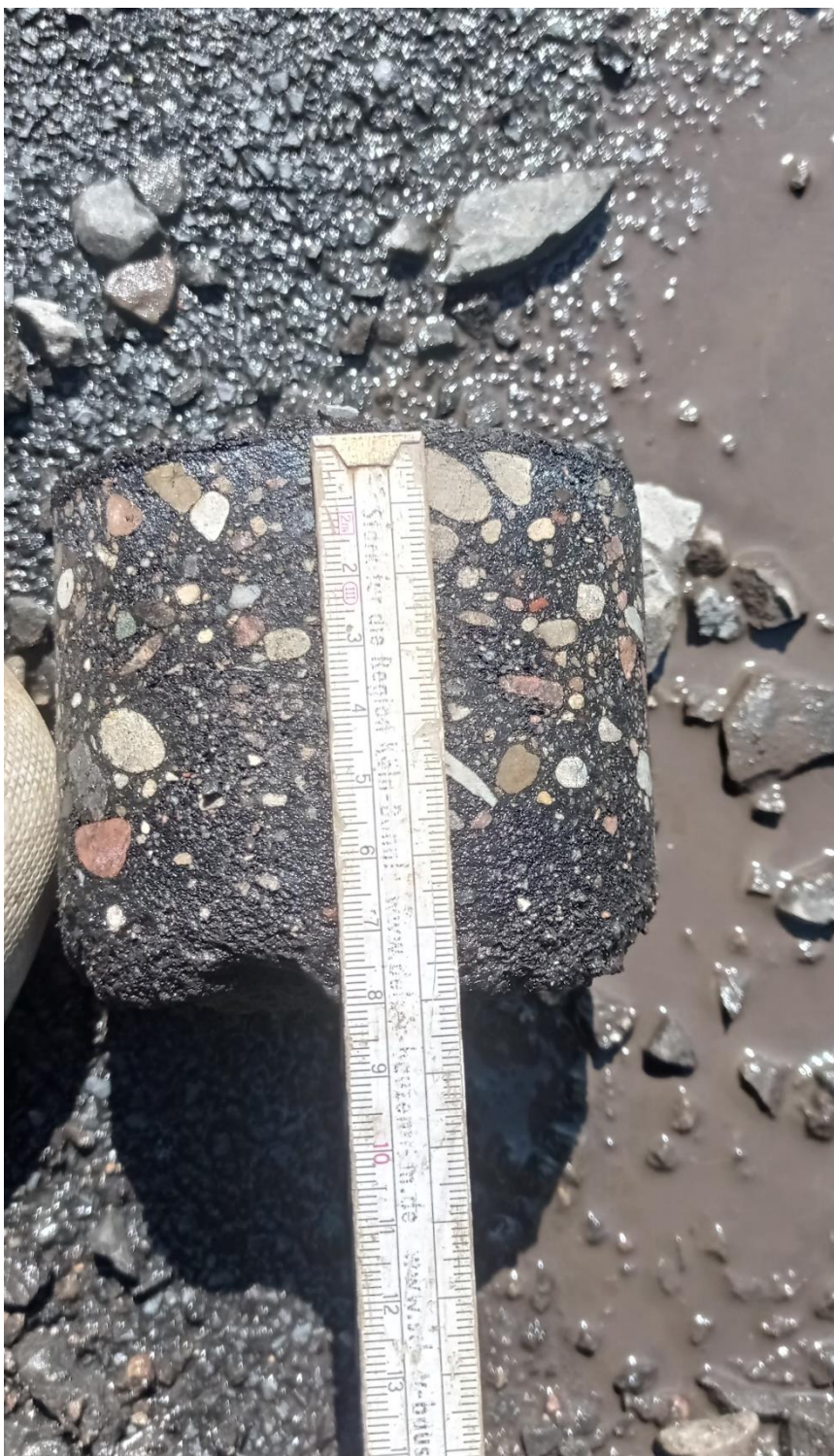
Fot. 2. Konstrukcja istniejącej nawierzchni drogi przy otworze nr 6
