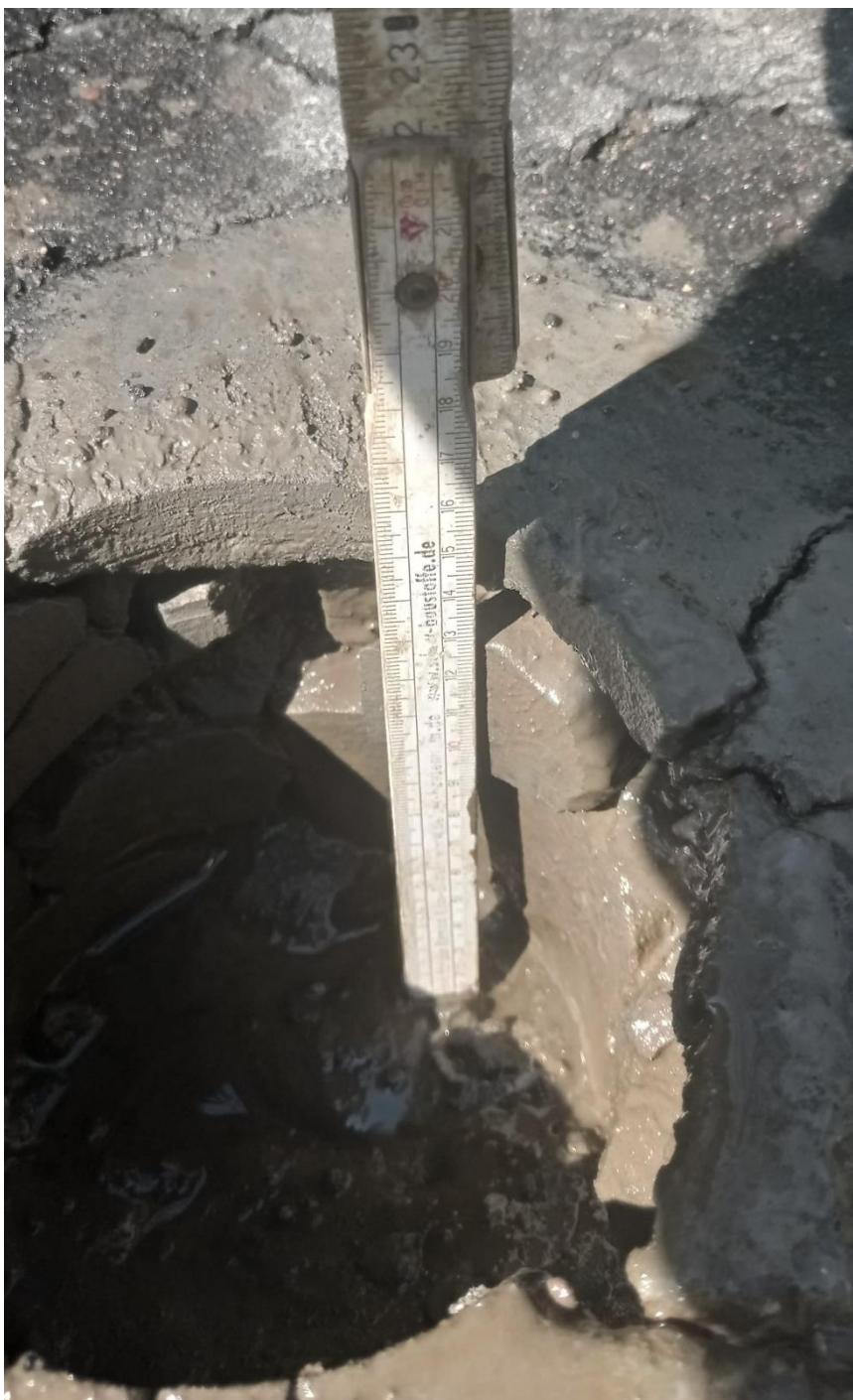
Fot. 4. Konstrukcja istniejącej nawierzchni drogi przy otworze nr 14
