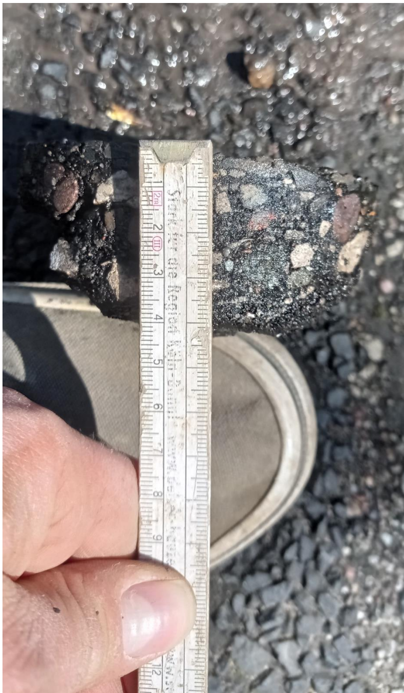
Fot. 1. Konstrukcja istniejącej nawierzchni drogi przy otworze nr 5
