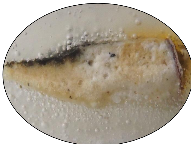
Odkrywka na połączeniu bazy, pilastra i tła portalu z widocznymi nawarstwieniami malarskimi. Obok przekrój poprzeczny zaprawy gipsowej z pilastra z warstwami malarskimi na powierzchni.
