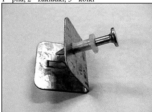
Rys. 5. Klips i kołek do mocowania siatki w podłożu. Klips zakłada się na poprzeczny pręt stężący siatki
