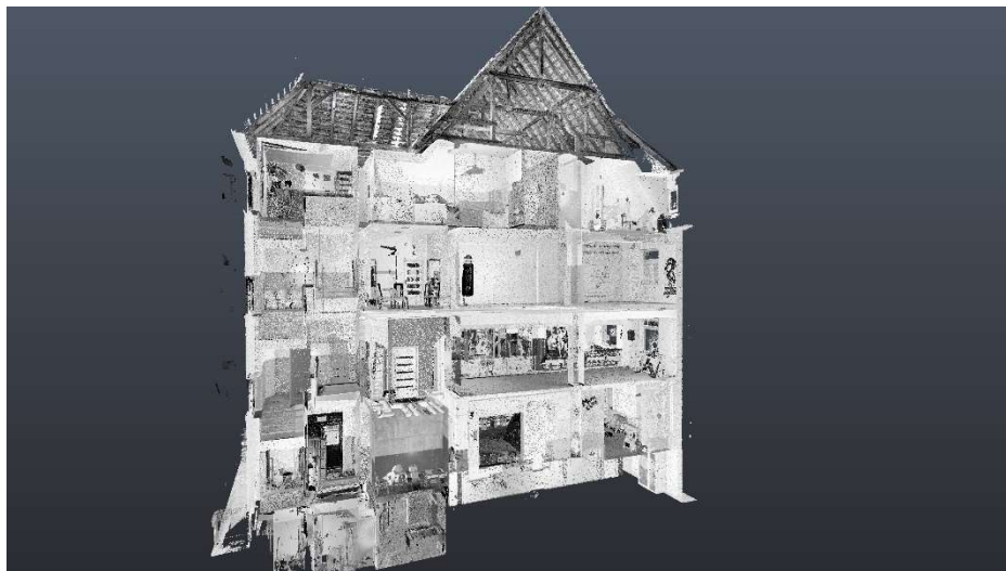
Fot. 6 Fragment widoku wnętrza budynku złożony z punktów pomiarowych.
