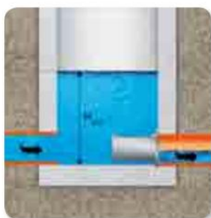
Rys. 9 Regulator korytkowy (DB) instalowany na mokro
