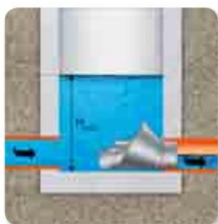
Rys. 8 Regulator stożkowy (C/E) instalowany na mokro
