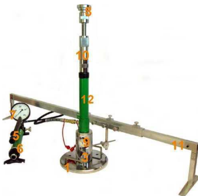
Rys. 1.2 Aparatura VSS z jednopunktowym pomiarem przemieszczenia płyty
