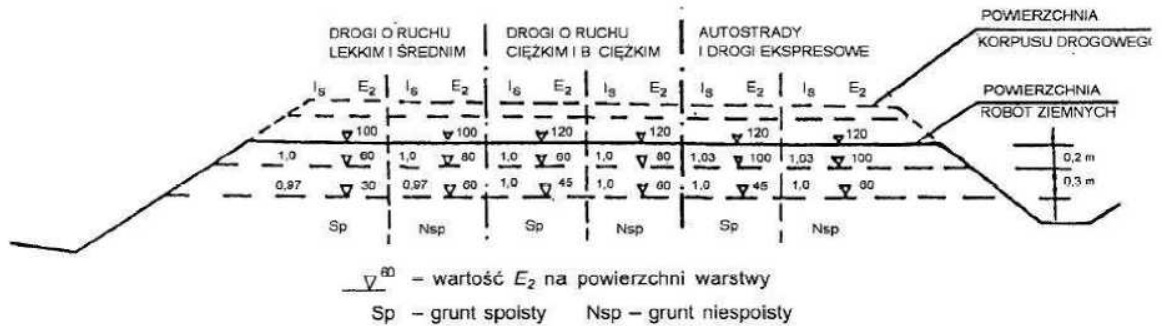
Rysunek 4 – Wartości wymagane w podłożu wykopów: wskaźnika zagęszczenia I_s i wtórnego modułu odkształcenia E_2 , megapaskali
