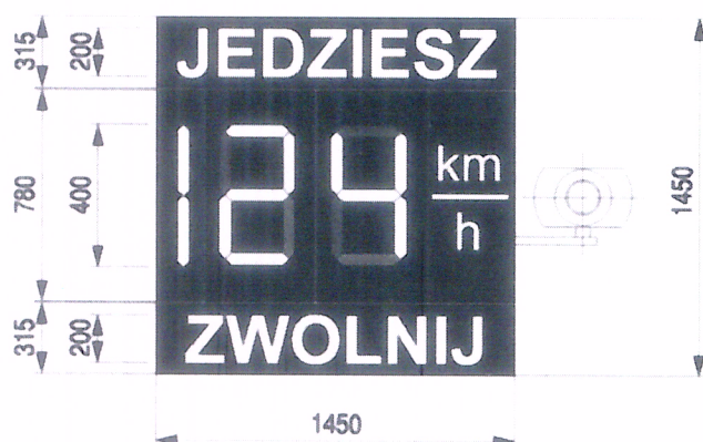
Rys. 13.6.1. Przykładowy wyświetlacz prędkości rzeczywistej z detektorem radarowym
