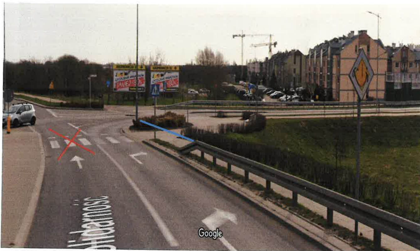
LIKwidACJA PRZEJSCIA I PRZEJAZDU, PRZEDŁUZENIE BARIERY ENERGOCHŁONNEJ
