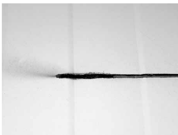
Fot. nr 6 i 7. Cięcia nie należy wykonywać szlifiereką kątową ze względu na niszczenie powłok antykorozyjnych.
