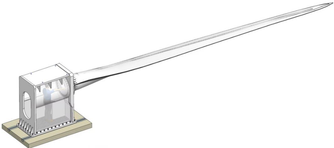
Rys. 1.1 Widok ogólny konstrukcji wsporczej i fragmentu podłoża, do którego konstrukcja będzie zamocowana.
