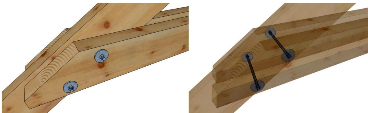
Rys. 1. Połączenie krokwi z jętką dwugąłęziową z zastosowaniem podwójnych śrub [fachowydekarz.pl]
