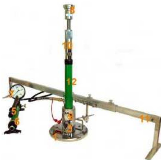
Rys. 1.2 Aparatura VSS z jednopunktowym pomiarem przemieszczenia płyty
