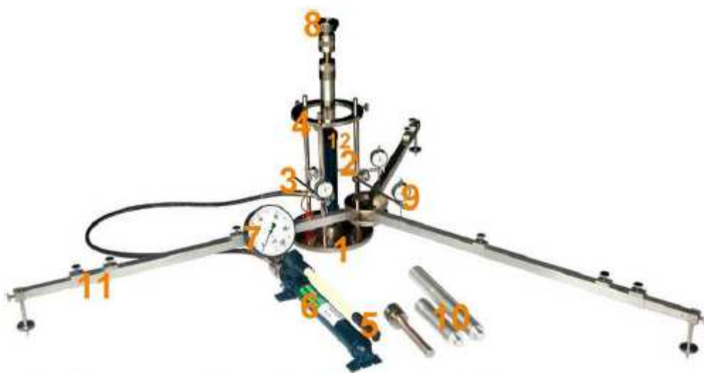
Rys. 1.1. Aparatura VSS z trzypunktowym pomiarem przemieszczenia płyty
