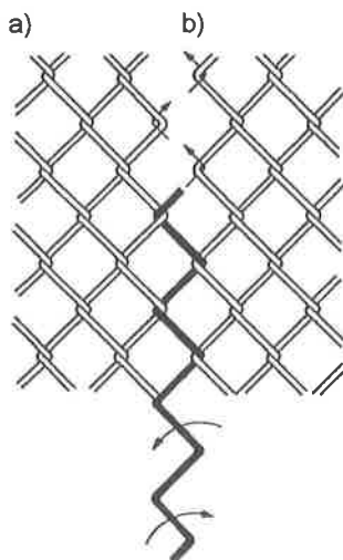
Rys. 2. Łączenie dwóch sąsiednich odcinków siatki za pomocą spirali wyplecionej z siatki i wprowadzonej w oczka siatki ruchem śrubowym (wg [6])
