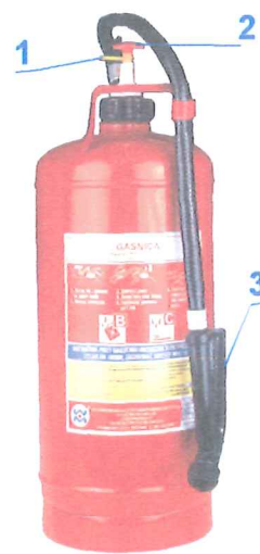
Rys. 2 Gaśnica proszkowa typu Z (a) 6, b) 12 kg proszku gaśniczego 1- zawleczka, 2-dźwignia uruchamiająca, 3-wąż gumowy zakończony zaworem.
