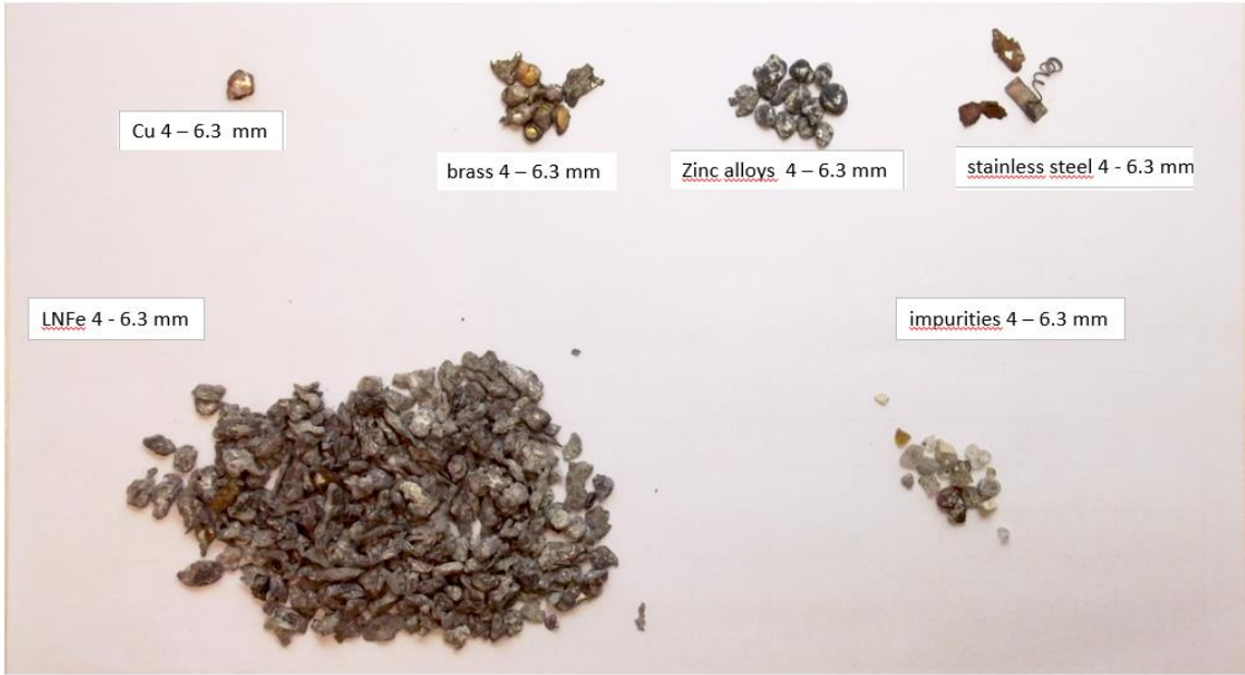
Rysunek 3.6 Przykłady form występowania metali o frakcji 4 – 6,3 mm.
