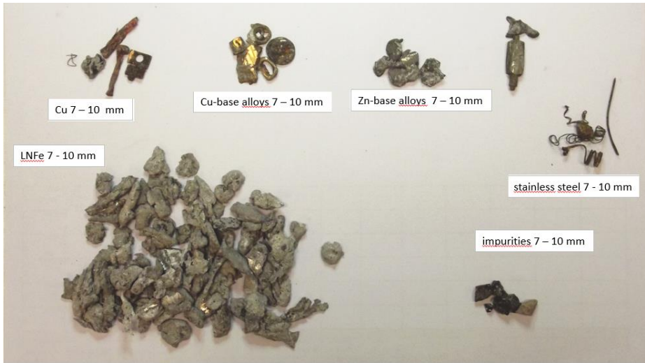
Rysunek 3.5 Przykłady form występowania metali o frakcji 7 – 10 mm.
