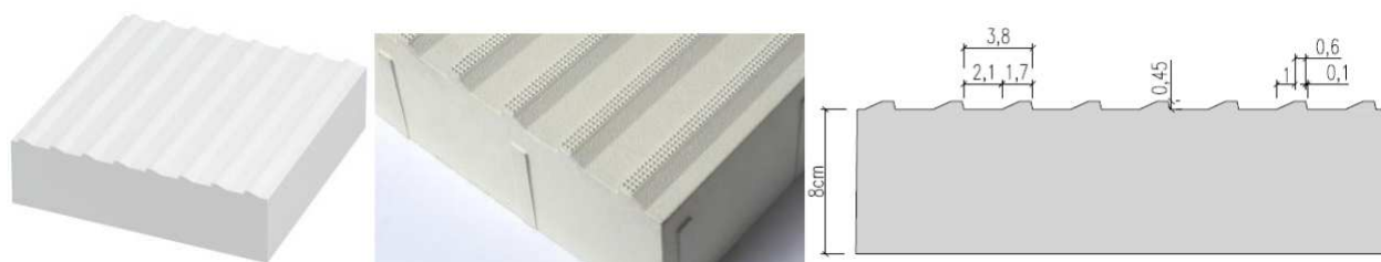
Rys. 1c. Płytki kierunkowe z wypustkami trapezoidalnymi asymetrycznymi - (stosowane tylko na pochylniach dla wózków inwalidzkich).
