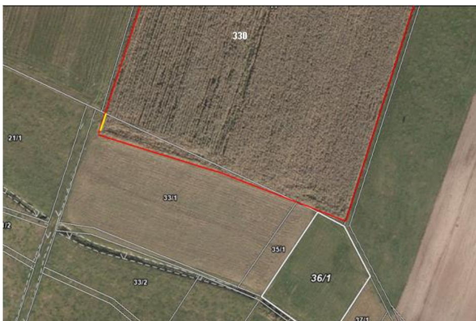
Rys. 44. Odchyłka wektora pomiaru działki rolnej A i granic odniesienia działki referencyjnej 330 jest większa od maksymalnej odchyłki dopuszczalnej dla danej metody pomiaru, ale powierzchnia obszaru wychodzącego poza wartość dopuszczalnej odchyłki jest mniejsza od 0,01ha
