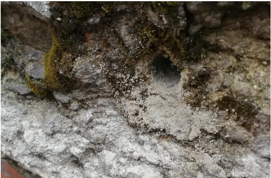
Fot. 12 Zawilgocone zwierciny w odwiertach.
